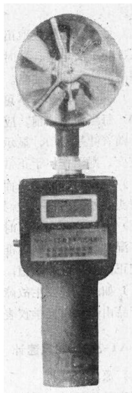
图 14-1-6 MSF-1型数字式风速表
