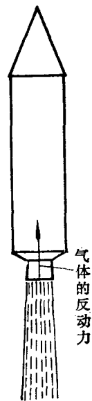
图 1-7 火箭工作原理示意图
