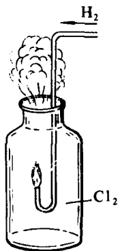
图 1-5 氢气在氯气里燃烧
