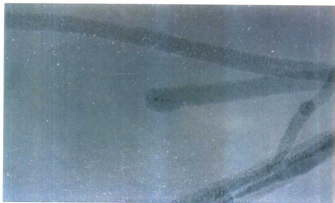
纳米碳纤维 \varnothing 20\text{nm} 左右(照片由中国科学院金属研究所提供)
