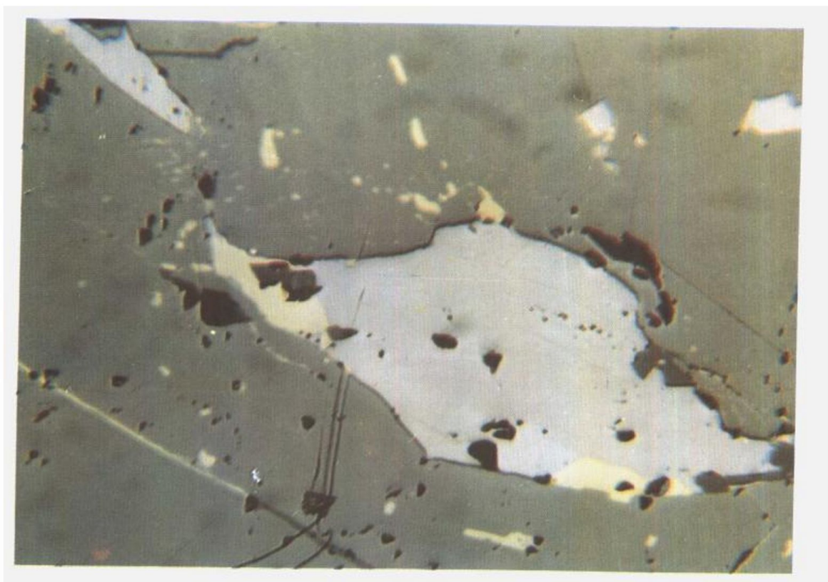
照片27 产于铁闪锌矿（深灰色）中的威硒硫铋铅矿（灰白色），浅黄色者为黄铜矿拉么，光片， \times 200
