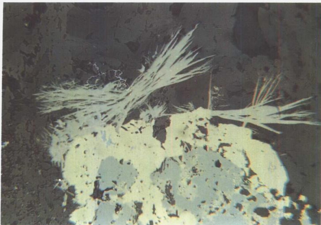
照片13 扫帚状磁黄铁矿（灰白色）和黄铜矿（黄灰色）、铁闪锌矿（蓝灰色）共生 茶山，光片， \times 200
