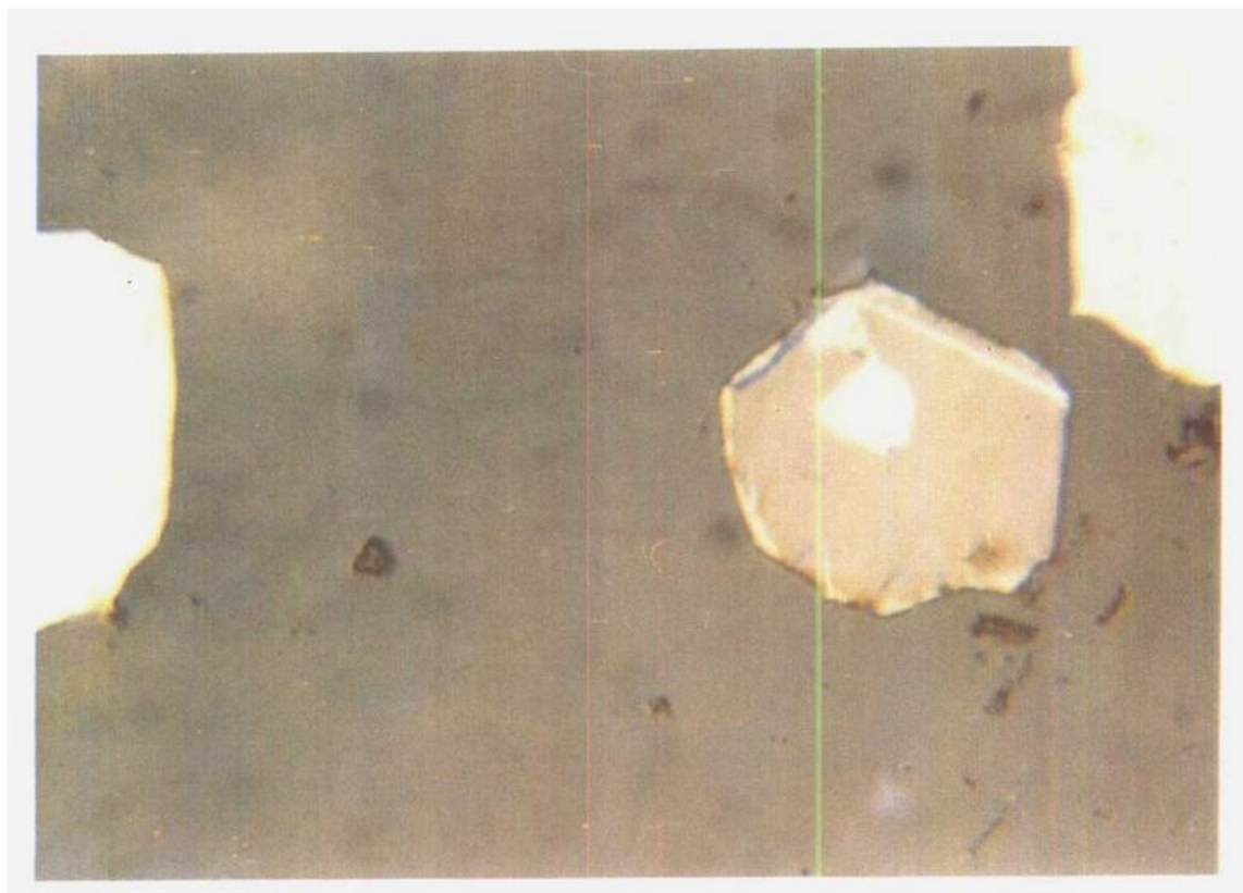
照片11 产于铁闪锌矿中的斑铜矿（棕红色），黄白色者为黄铜矿 拉么，光片， \times 500
