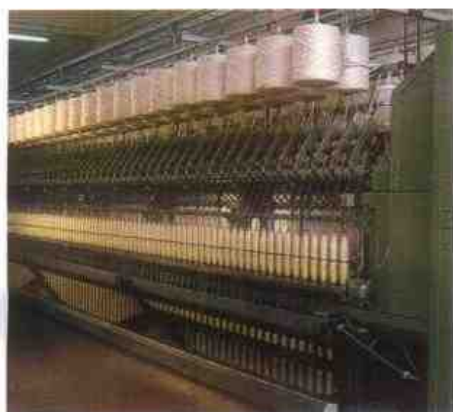
FP 99 指型毛精纺细纱机 —产量较传统细纱机高 40%—100% —可纺支数由 Nm10—Nm120
