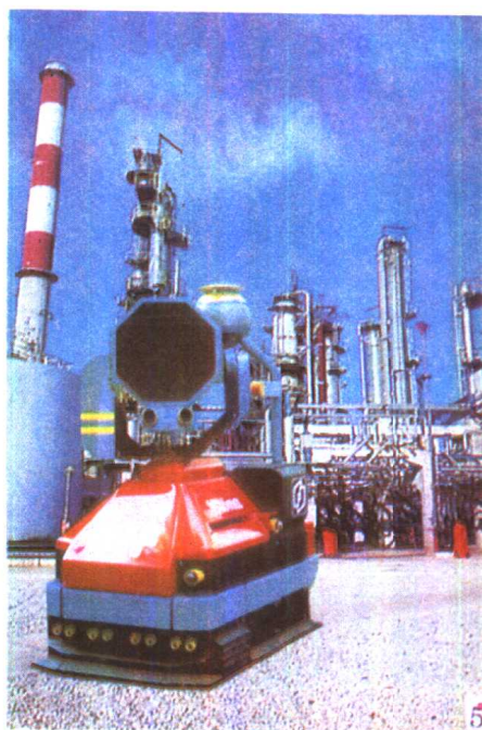
法国的机器人产品：1. VERI型放射环境作业机器人；2. VERI型核电站用移动式机器人；3. MA 23 核电站用遥控机械手；4. PLA2自重15吨，可深潜6000米的程控机器人；5. 石油精炼厂自动监控机器人
