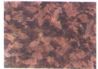
名称: 柳埠红 C (name): (LIUBU RED) C 产地: 山东 (Shandong) 抗压强度: 208.00MPa 抗弯强度: 21.27MPa 编号: JGHS 126
