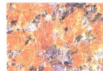
名称: 西丽红 B (name): (XILI RED) B 产地: 广东 (Guangdong) 抗压强度: 190.30MPa 抗弯强度: 9.60MPa 编号: JGHS 057
