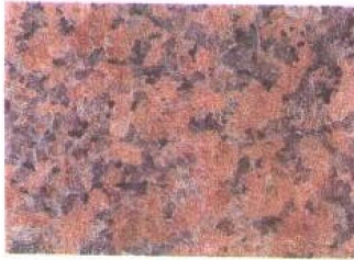
名称: 柳埠红 D (name): (LIUBU RED) D 产地: 山东 (Shandong) 抗压强度: 208.00MPa 抗弯强度: 21.27MPa 编号: JGHS 127
