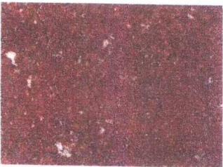
名称: 四川红 A (name): (SICHUAN RED) A 产地: 四川 (Sichuan) 抗压强度: 162.6MPa 抗弯强度: 17.10MPa 编号: JGHS 106
