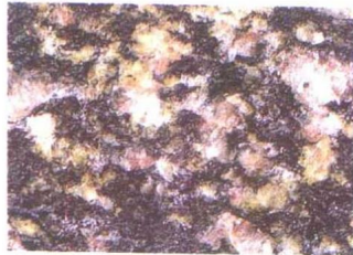
名称: 孔雀绿 (name): (PEACOCK GREEN) 产地: 山东 (Shandong) 抗压强度: 177.00MPa 抗弯强度: 13.30MPa 编号: JGHS 187
