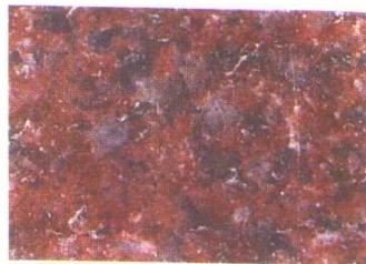
名称: 石岛红 (name): (PENINSULA RED) 产地: 山东 (Shandong) 抗压强度: 239.00MPa 抗弯强度: 13.90MPa 编号: JGHS 143
