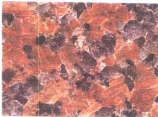
名称: 川絮红 (name): (CHUANXU RED) 产地: 四川 (Sichuan) 抗压强度: 99.40MPa 抗弯强度: 16.30MPa 编号: JGHS 104
