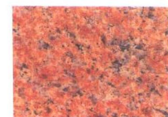
名称: 岑溪红 B (name): (CENXI RED) B 产地: 广西 (Guangxi) 抗压强度: 120.37MPa 抗弯强度: 12.60MPa 编号: JGHS 060
