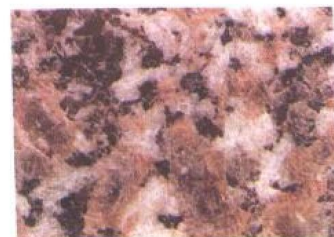
名称: 五莲红 (name): (WULIAN RED) 产地: 山东 (Shandong) 抗压强度: 92.00MPa 抗弯强度: 8.50MPa 编号: JGHS 069
