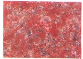
名称: 巨星红 (name): (GIANT-STAR RED) 产地: 四川 (Sichuan) 抗压强度: 13.97MPa 抗弯强度: 2.60MPa 编号: JGHS 129
