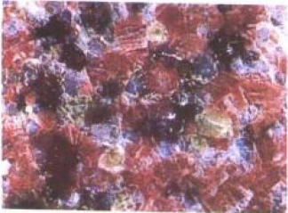
名称: 三峡红 A (name): (THREE-GORGES RED) A 产地: 湖北 (Hubei) 抗压强度: 12.94MPa 抗弯强度: 13.10MPa 编号: JGHS 079
