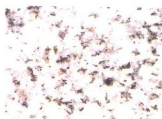
名称: 芝麻白 A (name): (SESAME WHITE) A 产地: 江西 (Jiangxi) 抗压强度: 219.00MPa 抗弯强度: 18.60MPa 编号: JGHS 008
