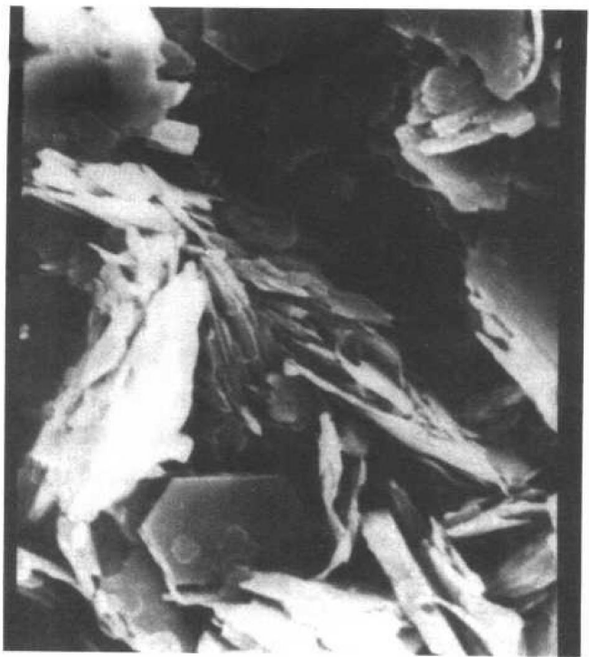
图 1.1 粘土（高岭土含量高）在电子显微镜下的照片 [1] 。
