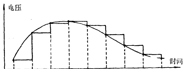
图 1-4 由采样值恢复模拟信号
