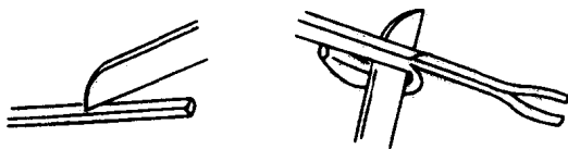
图 1-28 用电工刀剖削护套线
