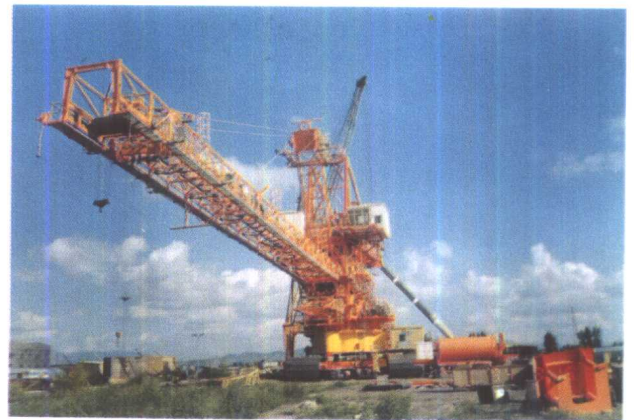
平庄矿务局元宝山露天矿从德国进口的挖掘机每小时挖掘能力为 3600 立方米，自重 2700 吨，是国内最大的轮斗挖掘机
