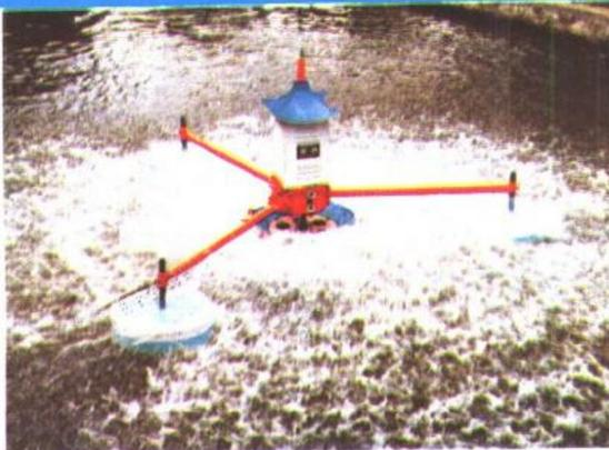
“鱼乐牌”ZY系列叶轮增氧机，是在原有YL系列增氧机的基础上，从新改进的新机型，其特性非常优异，所采用的原料和加工工艺都经过特别精选而制造，所以重量轻，非常耐用。根据机械电子工业部ZBB-94003-89《叶轮增氧机试验方法》测试充氧能力和动力效率，均达到同类产品的上乘标准。
