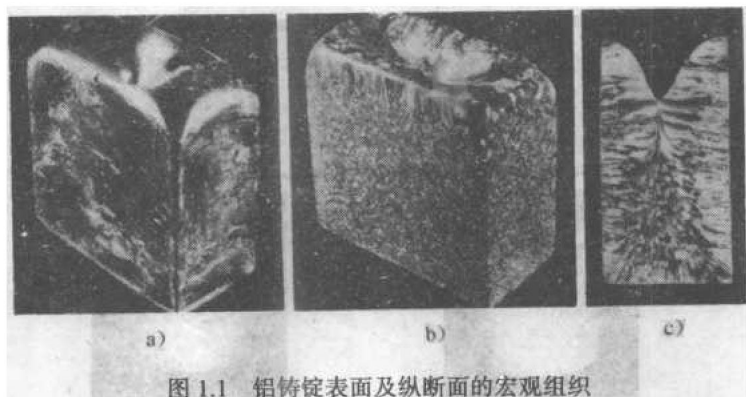
图 1.1 铝铸锭表面及纵断面的宏观组织
