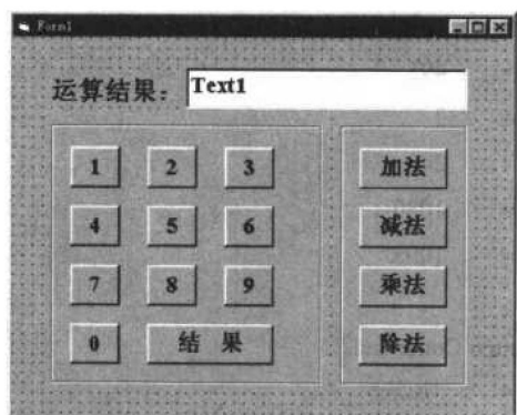
图 1-4 添加输出控件后的窗体
