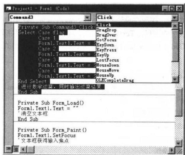
图 1-6 选择“结果”按钮的响应事件
