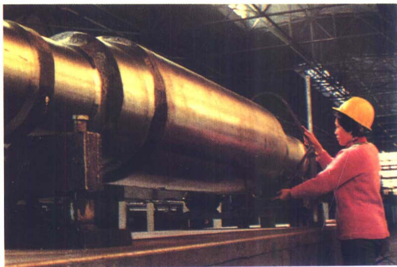
齐齐哈尔钢厂生产的合金钢冷轧辊坯
