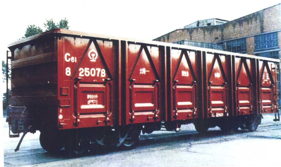
用武钢生产的耐候钢制造的 的车厢
