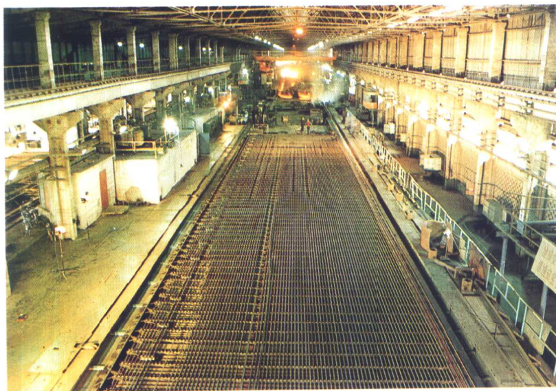
上钢三厂的螺纹钢钢筋钢生产线
