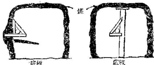
图 3 水管架在煤壁上
