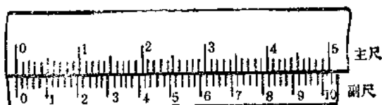
图 1-7 0.02毫米游标卡尺的刻线原理
