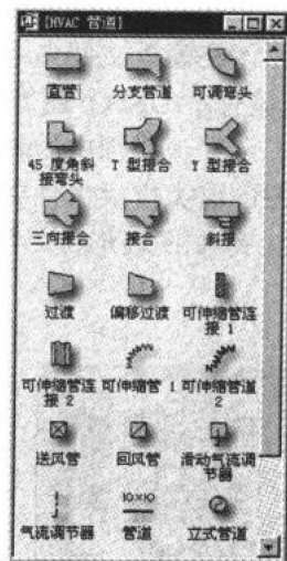
图 1.2 建筑设计图中的 HVAC 管道
