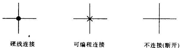
图 1.2 PLD 连接的表示方法
