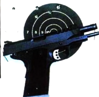
用 14.9g 的温彻斯特钢心弹在 约 23m 距离上的射弹散布
