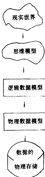
图 1-4 现实、数据模型与数据的物理存储之间的关系
