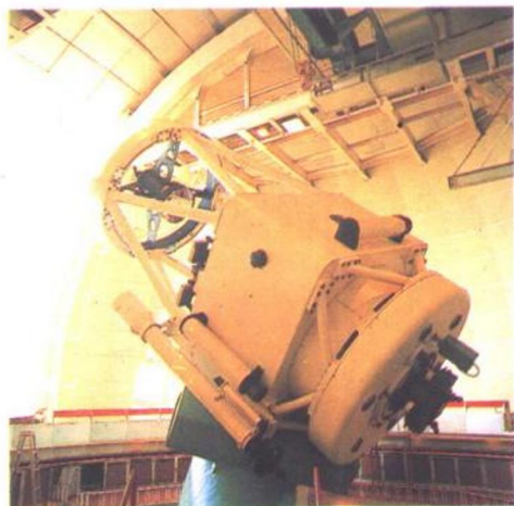
图 3 北京天文台兴隆站的 2.16 米反射式天文 望远镜,它是目前远 东最大的天文望 远镜,通过它可以观 测到相当于 20 000 千 米以外一根火柴亮 度的星体。
