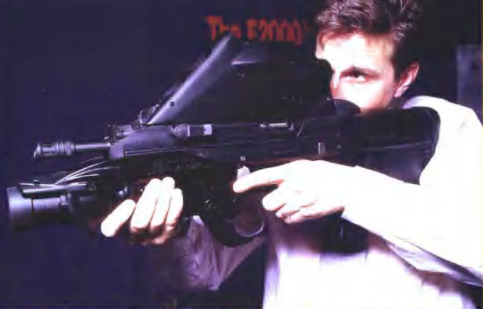
▲机头上方装有发射控制器的F2000，这一装置配合瞄准器，使射击更加精确。
