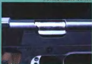
▼ 排壳孔被设计成故障少的喇叭形。
