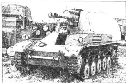
“黄蜂”在“装甲”II的底盘上安装了一门105毫米榴弹炮。
