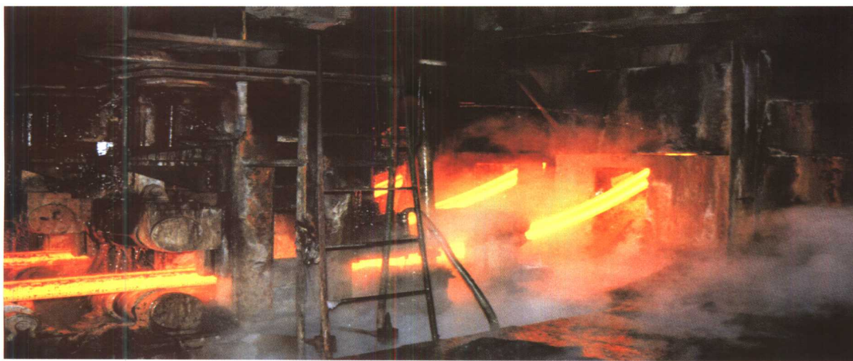
火红的钢坯正一支支从连铸机中拉出
