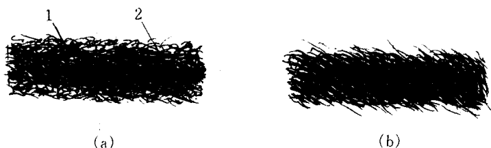
图 1-1-1 转杯纱和环锭纱结构图
