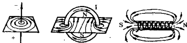
1. 直线电流磁场的磁力线；2. 环形电流的磁场方向；3. 螺线管电流磁场的磁力线。
