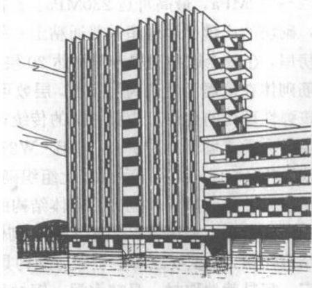
图 2 采用混凝土小型空心砌块 承重墙的高层办公楼
