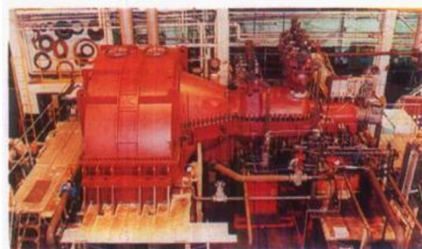
55,000KW单层自动抽汽。 蒸汽状态：10.34MPa-510℃。 抽汽在1.17MPa状态下进行。
