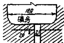
圖 3 用扇形深孔崩梯段。一組中砲孔過多，最小抵抗線很小
