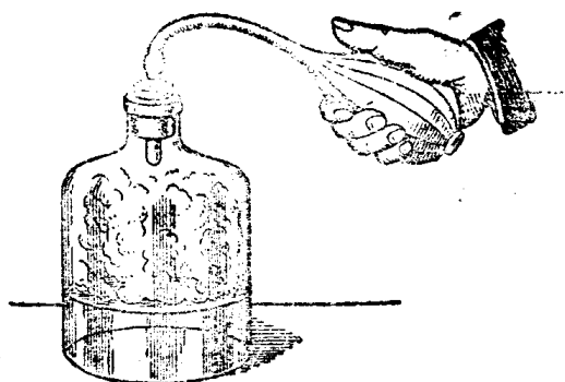
圖 1：證明空氣在膨脹時冷卻的試驗
