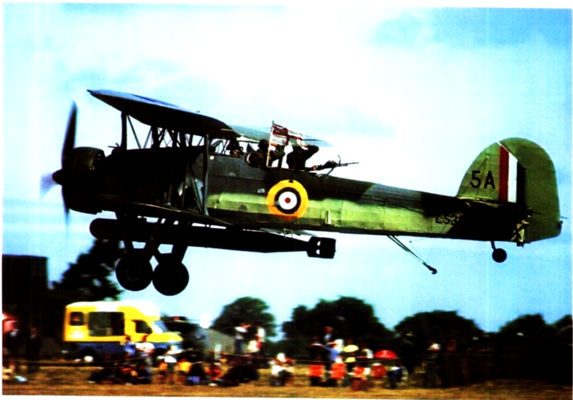
“旗鱼”（Swordfish） 英国费尔雷航空公司20世纪30年代研制的鱼雷轰炸机。双翼式布局，敞开式座舱，活塞式发动机。机上装2挺机枪，挂1条730千克鱼雷。
