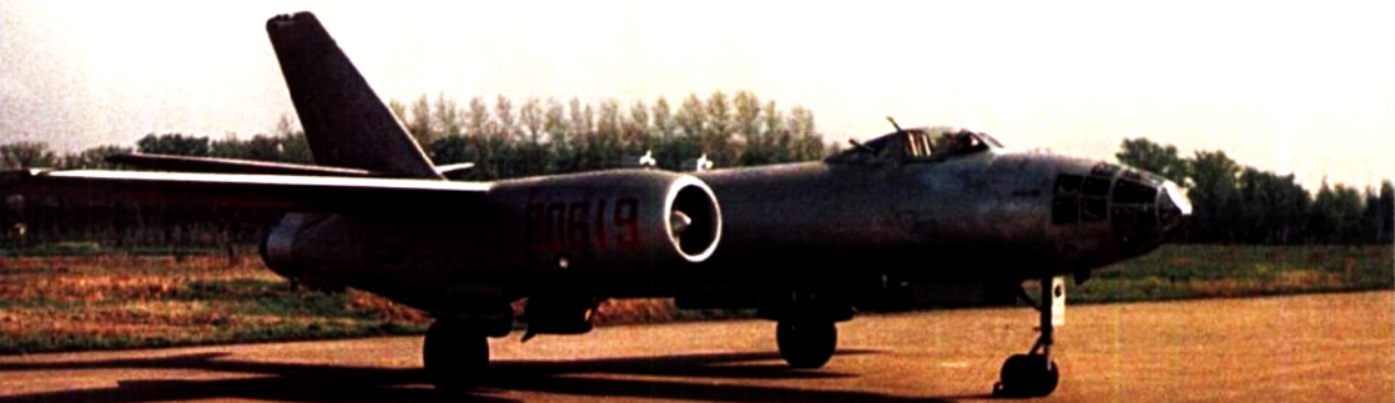
轰-5 (B-5) 中国哈尔滨飞机制造公司参照苏联伊尔-28轰炸机生产的亚声速轻型轰炸机。1966年9月首飞。该机可一年四季昼夜复杂气象条件下执行战术轰炸任务。正常载弹1000千克，最大载弹量3000千克。有基本型、改进型、鱼雷轰炸型、照相侦察型、轰炸教练型等多种改型。1984年停产。
