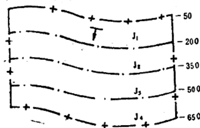
图 1—6 井田划分为阶段 : J_1, J_2, J_3, J_4 是第一、二、三、四阶段; -50 \sim -650 是底板等高线
