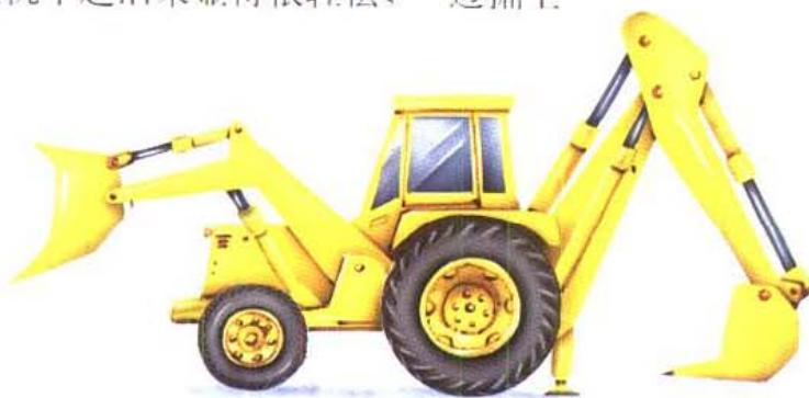
如图所示，常见的掘土机安装着铁镐一样的装置，能挖开坚硬的土层或柏油路面，另一侧安装着铁铲，把土块和柏油块铲起来。
