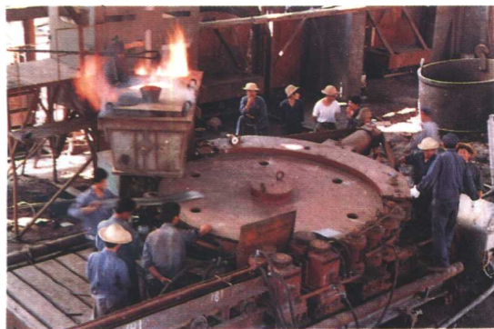
1981年在青岛钢厂进行的水平 轮式连铸机试验
