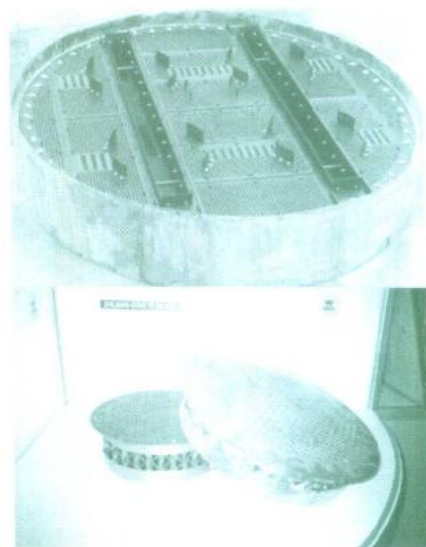
DJ™ 型塔板和复合塔板
