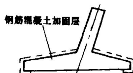
图 1-3 加筑钢筋混凝土加固层
