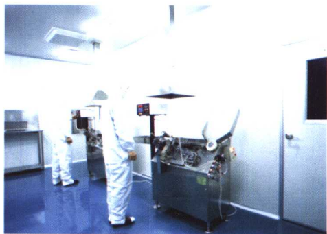
小容量注射剂车间灌封工序
