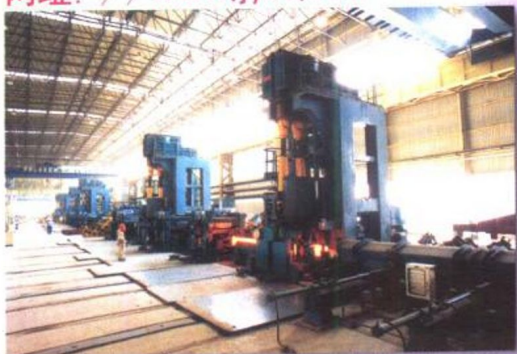
从德国引进的16机架高刚度连轧机组
