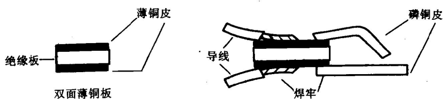
图 1-5 轻触开关的制作
