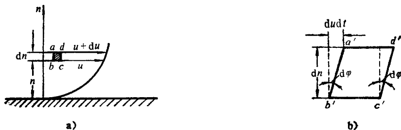
图1-4 流体微元平面的变形
