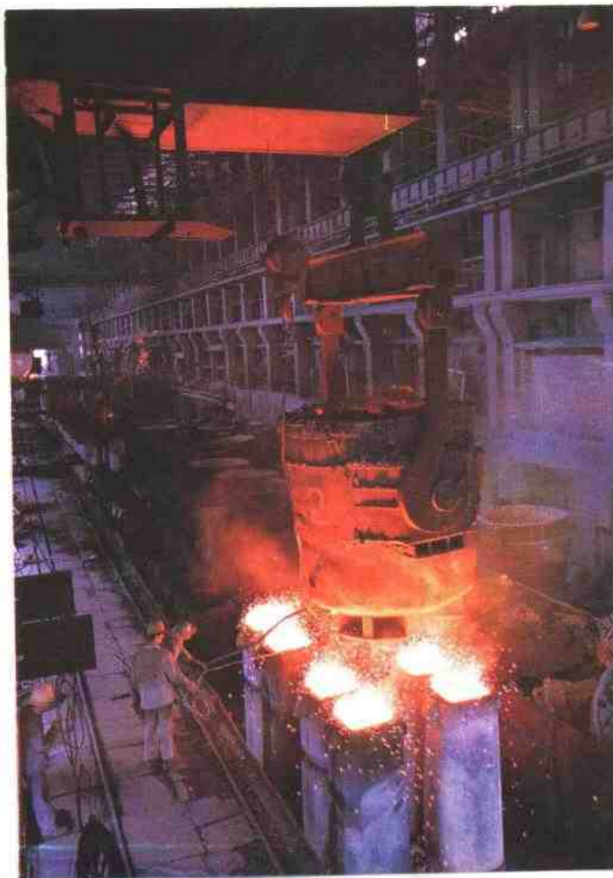
首钢第一 炼钢厂30吨转 炉出钢铸锭
