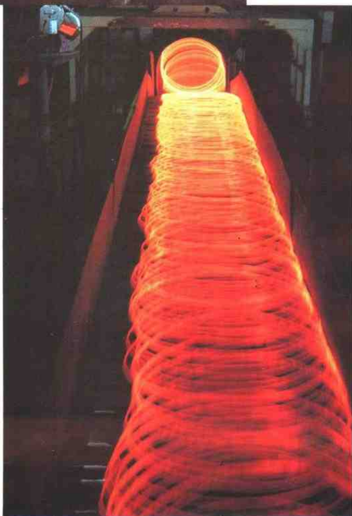
首钢第二线材厂 高速线材轧制吐丝机 在工作
