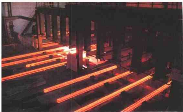
首钢第二 炼钢厂八流小 方坯连铸
