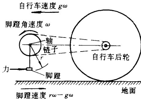
如图所示，设力引起脚蹬绕中轴旋转的角速度为  $\omega$ ，如果自行车的传动比为  $g$ ，那么自行车相对于地面前进的速度为  $g\omega$ 。此外，如果  $r$  是脚蹬的旋转半径，由于脚蹬是在它的最低位置，所以脚蹬相对于地面向后的速度是  $r\omega - g\omega$ 。既然脚蹬是力的作用点，其运动不会与力反向。如果脚蹬运动是  $(r-g)\omega \geq 0$ ，那么运动就是向后的。因此或者  $r > g$  且  $\omega \geq 0$ ，或者  $r < g$  且  $\omega \leq 0$ ，或者  $r = g$ 。但前面已指出自行车的速度是  $g\omega$ ，并且  $g > 0$ ，所以当  $\omega > 0$  时，自行车向前运动；当  $\omega < 0$  时，自行车向后运动。普通自行车  $r < g$ ，自行车向后运动。
