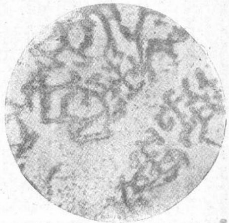
图1-4 Al+ \alpha ——(Fe-Si-Al) 共晶体。×400
