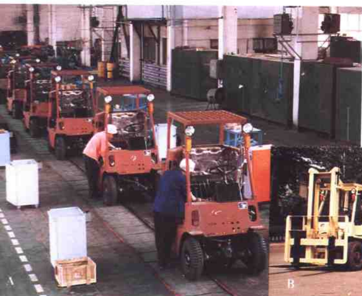
A. 1985 年竣工投产的全国第一条叉车总装流水线,年单班生产能力可达 5000 台
