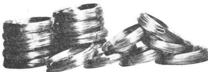
圆铝单线是一种广泛使用的裸单线，它在电缆工业中代替了很多原来使用铜线的品种，在贯彻“以铝代铜”的技术政策上，起着重大作用。圆铝单线，用于架空绞线、绝缘电线、电缆及电磁线作为导体，并供其他电器制品之用。由于铝的重量轻，因此虽然在抗拉强度和导电性能上比铜导体稍差，而在技术经济上仍然是优越的。现将硬铝线与硬铜线作一对比，在同样的抗拉强度下和在同样的导电性能要求下，采用铝线都较铜线为节省。
