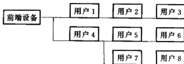
图 1.1.9 有线电视的用户接入网
