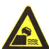
(78) 堤坝公路标志
