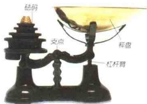
这是一架天平。过去,人们常用它称重。要让天平保持平衡,左边的砝码和右边秤盘里的东西重量必须相等。
